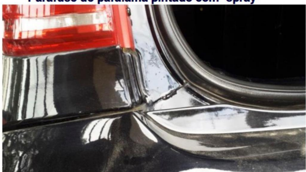
Painel traseiro descravado
