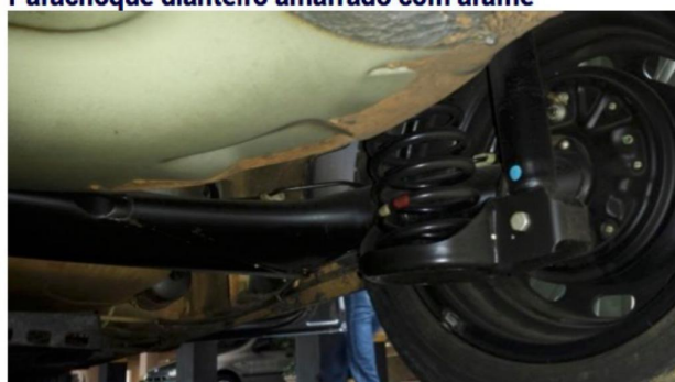
Eixo traseiro substituído
